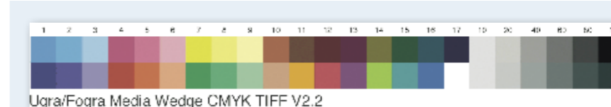
Fig. 9 – Ugra/Fogra Media Wedge. Hardproof og offsettrykk kontrolleres ved at de 46 målefeltene måles med spektrofotometer. Måleverdiene sammenliknes med standardens referanseverdier.
